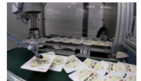
AIを活用した独自の認識技術により、重なり合った不定形物をピッキング
